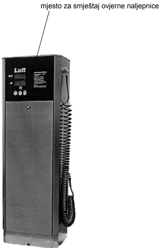
Slika 1: Fotografija tlakomjera za gume tip AutoAir s prikazom mesta za smještaj ovjerne naljepnice
